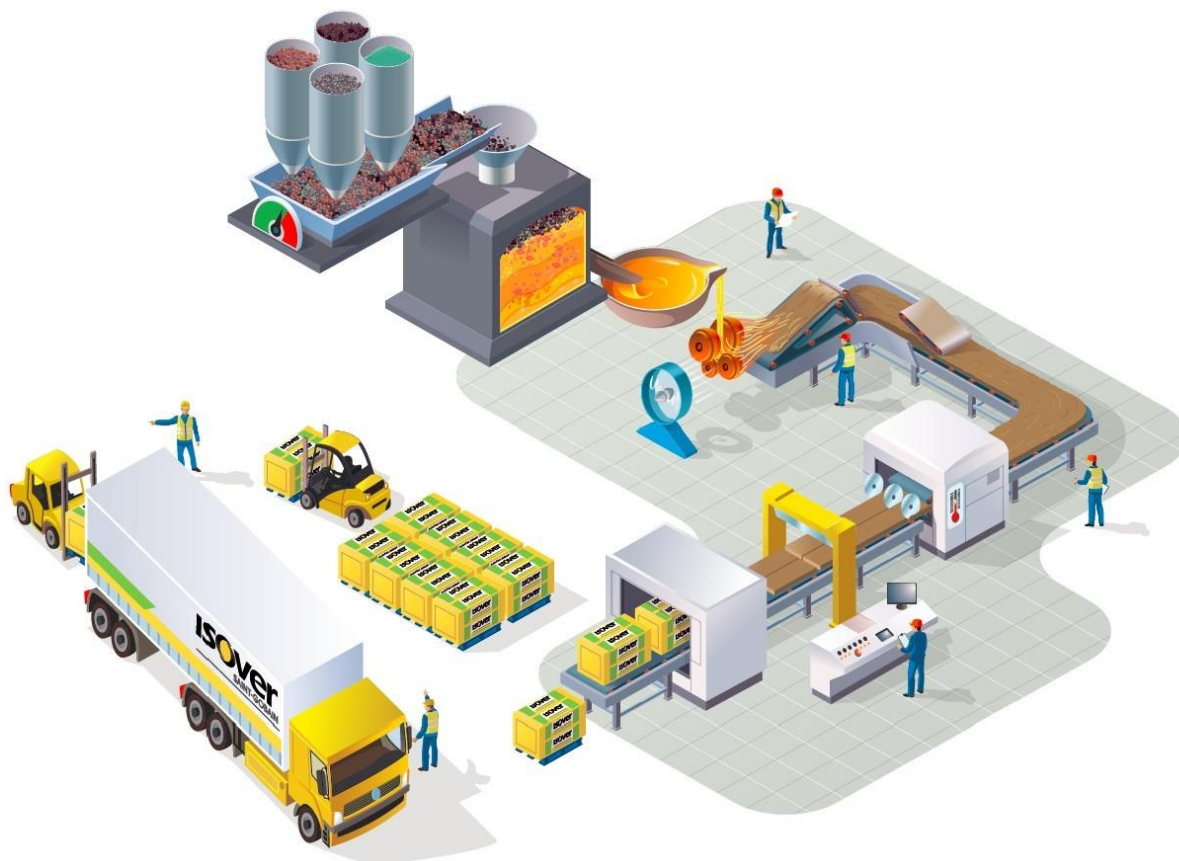
Obr. 3 – Schéma výroby minerální vlny
